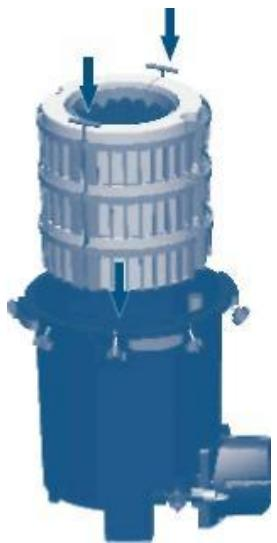
**3. Установите обратно и затяните вручную восемь креплений крышки.** Крышка считается установленной правильно, если она находится в непосредственном контакте с контейнером. **НЕ ПОЛЬЗУЙТЕСЬ КАКИМ-ЛИБО ИНСТРУМЕНТОМ, ТАК КАК ПРИ ЭТОМ МОЖЕТ БЫТЬ ПОВРЕЖДЕН ФИЛЬТР.**
