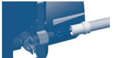
**5. Сначала переведите продувочный клапан в открытую (горизонтальную) положение, повернув его против часовой стрелки; затем отсоедините впускной клапан “IN”: нажмите кнопку, отпускающую его, и отделяйте ее от крышки фильтра. При снятии клапана AquaStop проливается некоторое количество воды, поэтому лучше запастись тряпкой для вытирания ее.**
