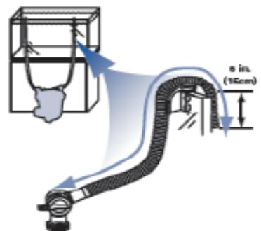
**3. Втолкните обрезанный конец стоякового шланга в резиновый соединитель на трубе стояка.** Втолкните шланг не менее чем на 2,5 см без скручивания его.
