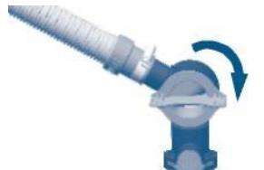
**4. Отсоедините клапан AquaStop и выпускной шланг от соединения “OUT” на крышке фильтра. Затем присоедините третий клапан AquaStop и дренажный шланг (приготовленный в соответствии с пунктом 1 выше) к соединению “OUT”.**
