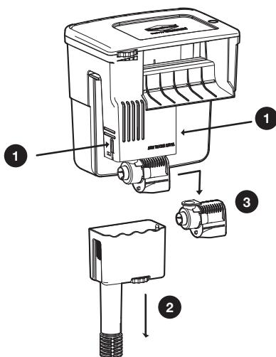
Для технического обслуживания насоса, следуйте изложенным ниже рекомендациям (Рисунок 11): слегка нажмите пальцами на одну из сторон фильтра (1), наклоните вниз корпус насоса (2), освободите кабель питания из корпуса фильтра и переместите насос вправо (3). Для модели Tidal 55: переместите крышку всасывания насоса (4, Рис.11-В) для освобождения рабочего колеса (5).
